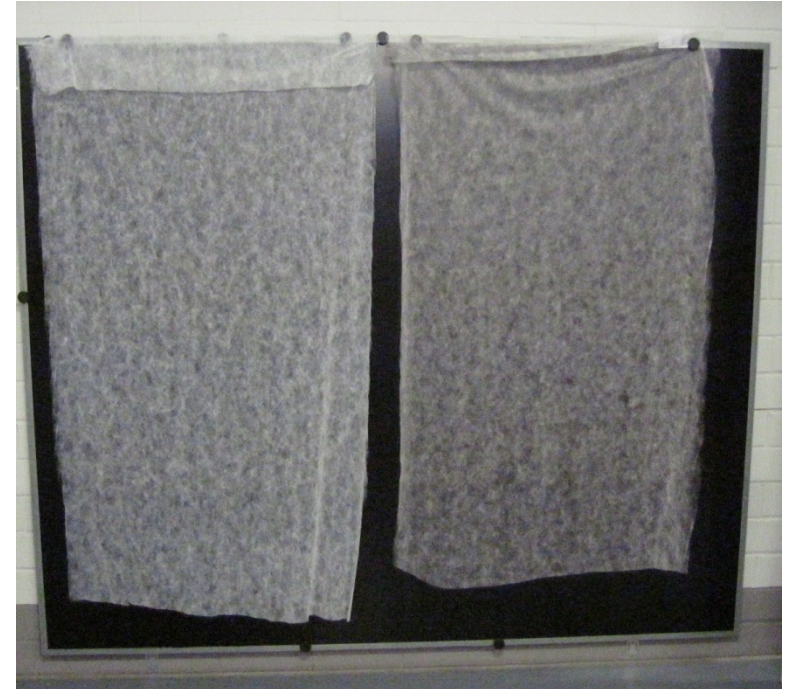
Manuelle Vliesbegutachtung an sog. Blackboard
