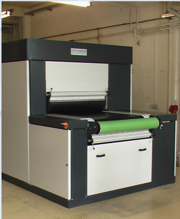
Thermofix®- Kaschieranlage von Schott & Meissner im STFI e.V.
