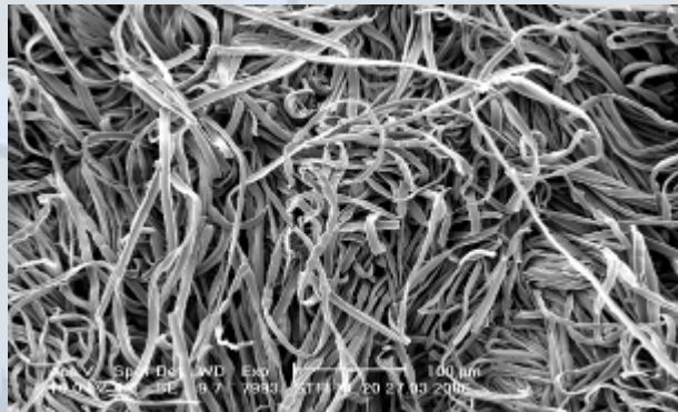
PPa/PET 60/40, 60 g/m 2 , 8m/min Wasserstrahl (Oberfläche)
